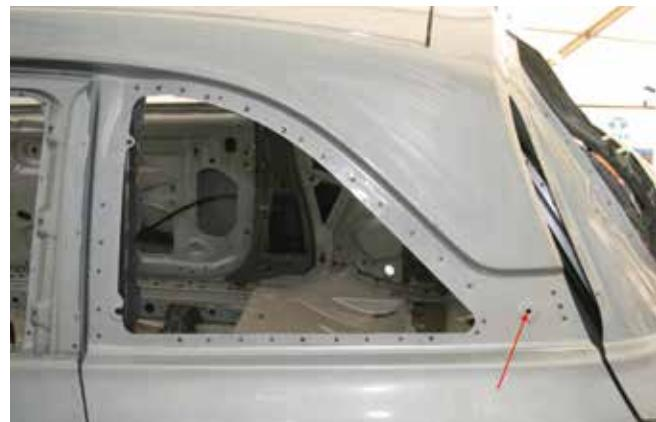
Les lignes de séparation de la peinture deux tons se trouvent sur le côté latéral arrière et le trou dans le pilier arrière (flèche) sert au pion de centrage de la vitre latérale arrière.
