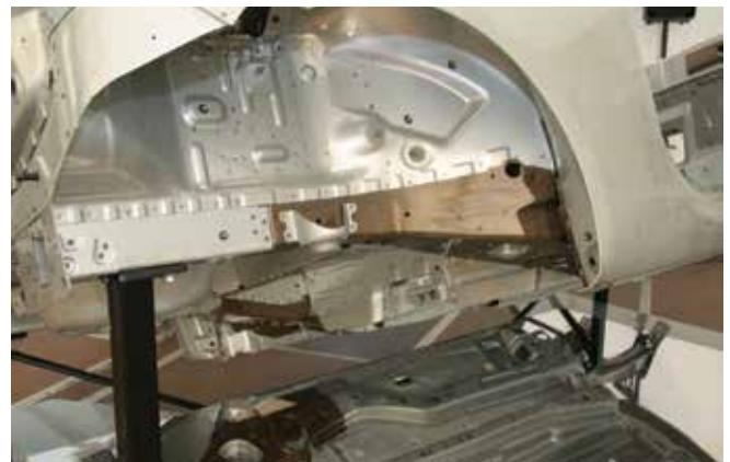
La vue sur le passage de roue arrière met en évidence le tracé du longeron avec sa partie en PHS allant de l'avant (à droite sur la photo) vers l'arrière.
