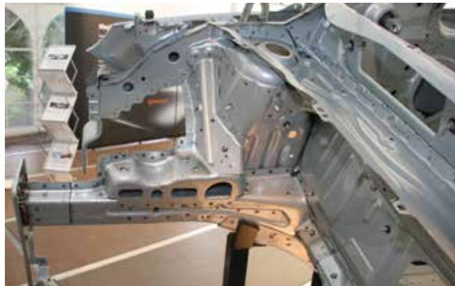
La partie avant du véhicule est assemblée par soudage par points, seuls les éléments de fixation du système de pare-chocs sont montés par soudage MIG. Les longerons sont réalisés à partir d'un flan sur mesure (tailored blank).
