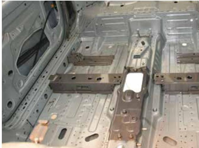
Les traverses hautement résistantes des sièges visibles sur le plancher du véhicule transmettent les forces latérales (l'énergie développée au moment de la collision) au côté opposé en passant par le tunnel.
