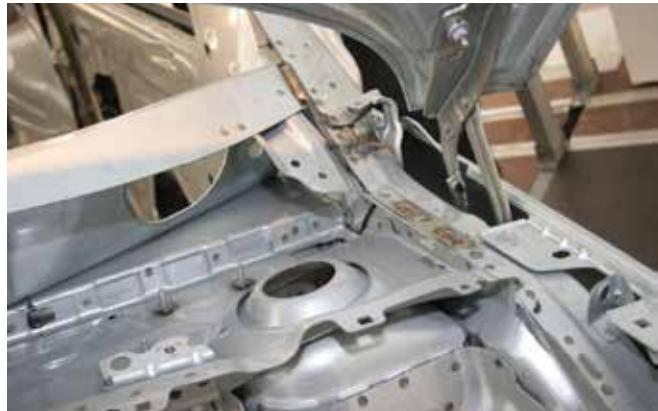
Les points d'assemblage accessibles d'un seul côté, par exemple au niveau de la calotte de suspension, du cadre du pare-brise avant ou du passage de roue arrière, sont réalisés par brasage MIG.
