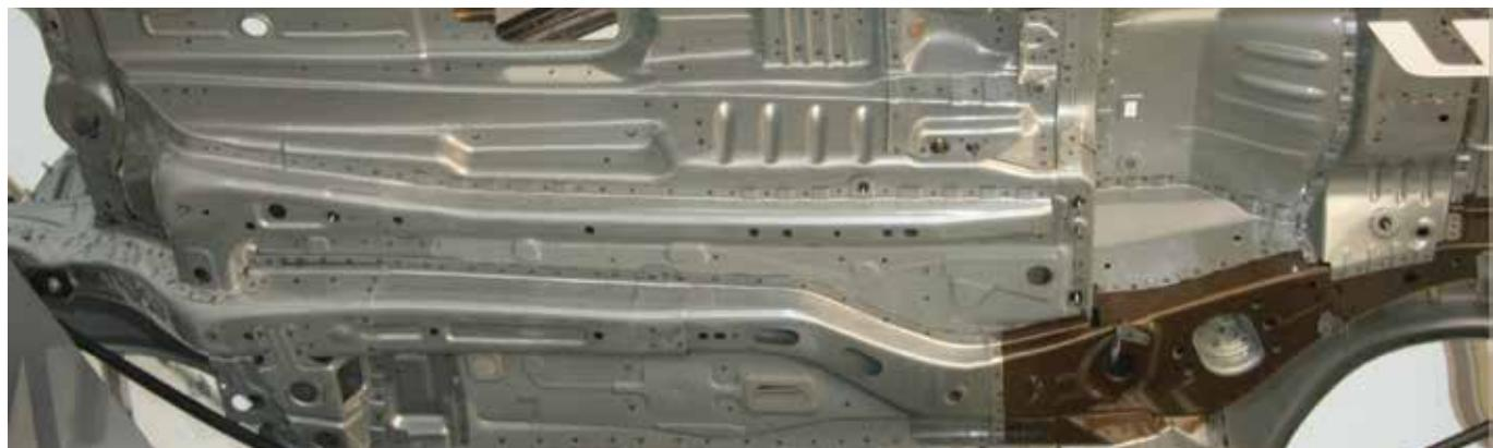
La vue sur la partie inférieure de la carrosserie montre le tracé du longeron de l'avant (à gauche) vers l'arrière avec son élément en tôle PHS dans la partie arrière du longeron (couleur marron). Le renfort en forme de ski du plancher du véhicule se trouve entre le longeron et le tunnel.
