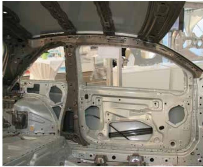
Les renforts en tôle à haute et très haute résistance du pilier central, du cadre du toit et des traverses de pavillon contribuent à la stabilité de l'habitacle. La partie intérieure du pilier central est réalisée sous la forme d'un élément en tôle PHS embouti à chaud.
