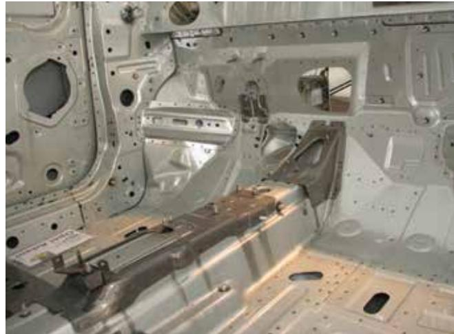
Les tôles de renfort hautement résistantes sont visibles au niveau du tunnel et de la jonction avec le tablier.
