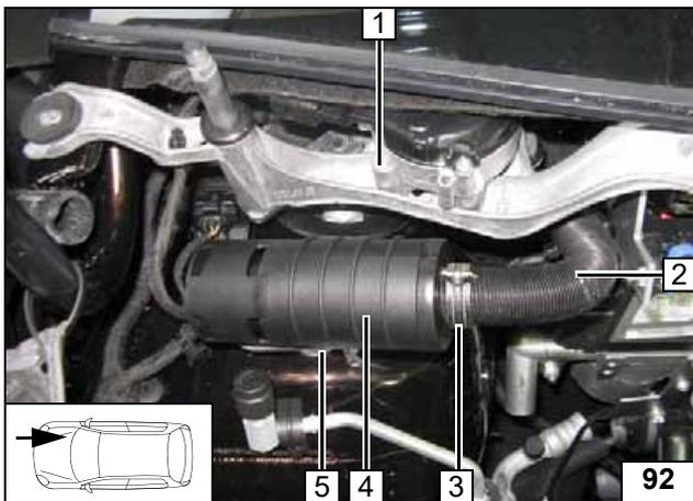
Auf Bewegungsfreiheit zwischen Brennluftleitung 2 und Scheibenwischergestänge achten, ggfs. korrigieren!
